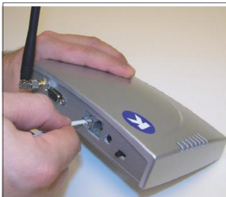
Tilslutning af forbindelseskablet.
