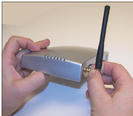
Montering af standardantenne.
